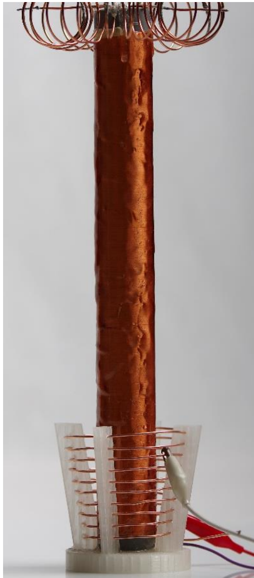
Slika 3: Sekundarno navitje premazano z epoxy-em
