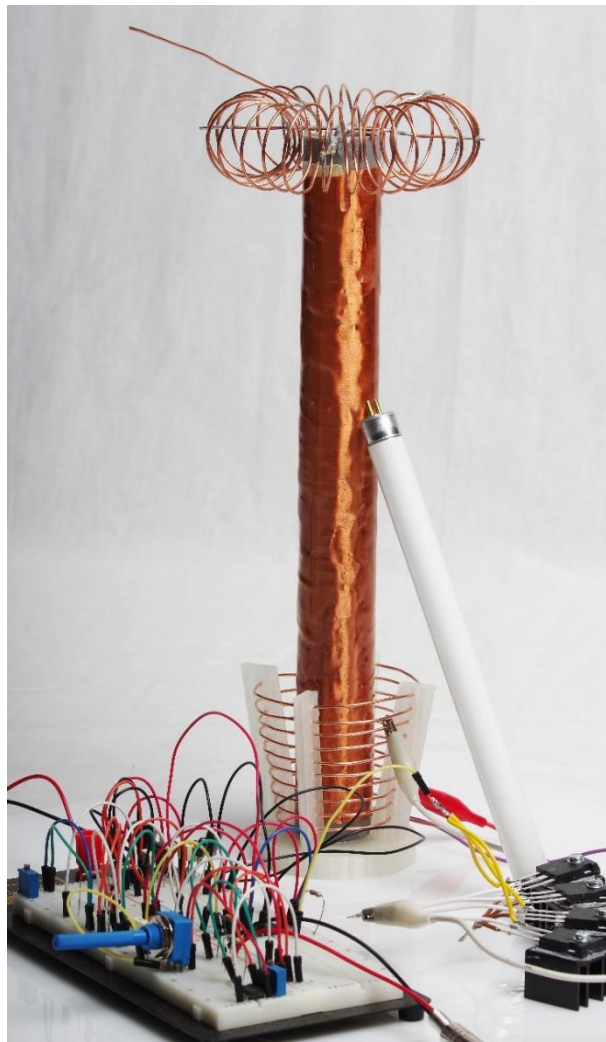
Slika 12: Tuljava priklopljena na vezje, s prislonjeno neonsko žarnico
