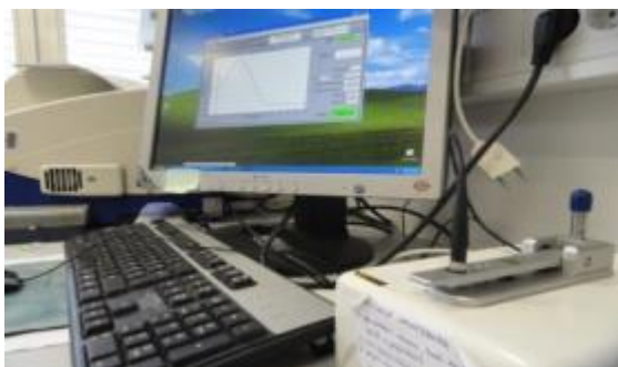
Slika 13: Spektrofotometer NanoDrop v Laboratoriju za biotehnologijo na Kemijskem inštitutu (foto: Ana Milovanović)
