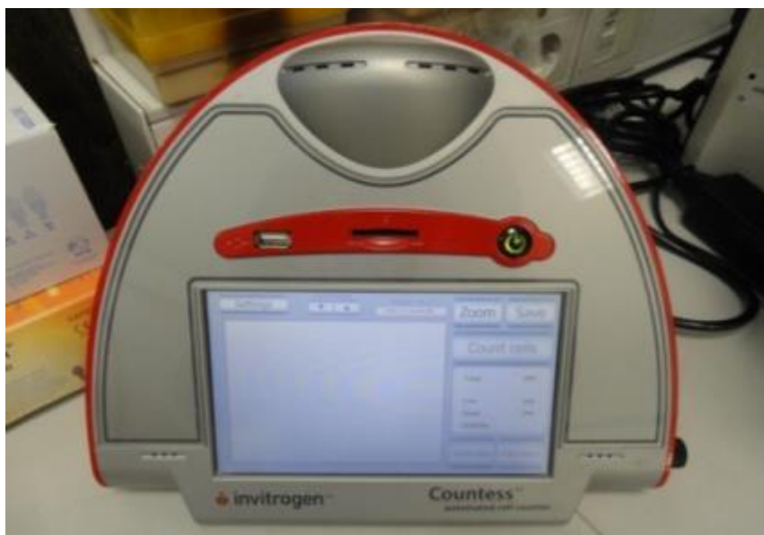
Slika 18: Naprava za avtomatsko štetje celic Countess TM v Laboratoriju za biotehnologijo na Kemijskem inštitut v Ljubljani (foto: Ana Milovanović)
