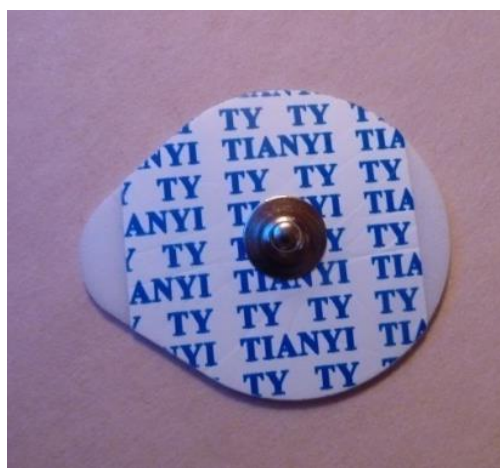
Slika 16: Gelirana elektroda Ag/AgCl (avtorica: Sara Črepinšek)
